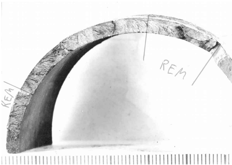
Bild 3 Bruchstelle I, Draufsicht, die rechts mit REM bezeichnete Stelle wurde näher untersucht
