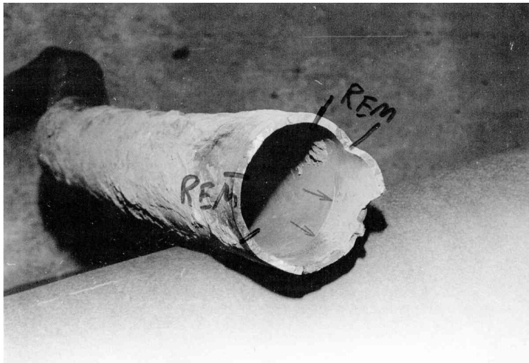
Bild 1 Bruchstelle I mit gezackten Rissufer; innen Walzkante markiert
