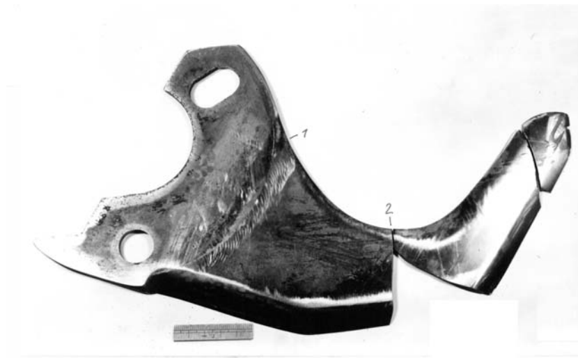
Bild 1: das gebrochene Kuttermesser
