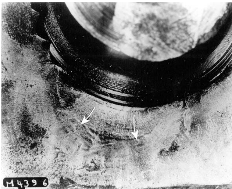
Bild 2: Draufsicht, Risshauptstart an Schraubenloch B
