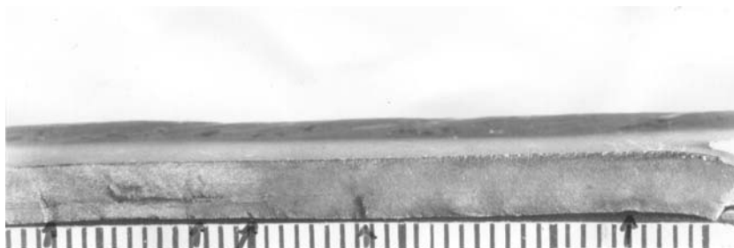
Bild 2: Blick auf die Bruchfläche; mehrere Risse sind von der Innenwand her eingelaufen (Aufnahme: SATÜ)
