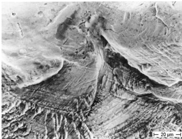
Abb. 3 Das Risseinlaufgebiet mit schon gut erkennbarem Spaltbruchcharakter
