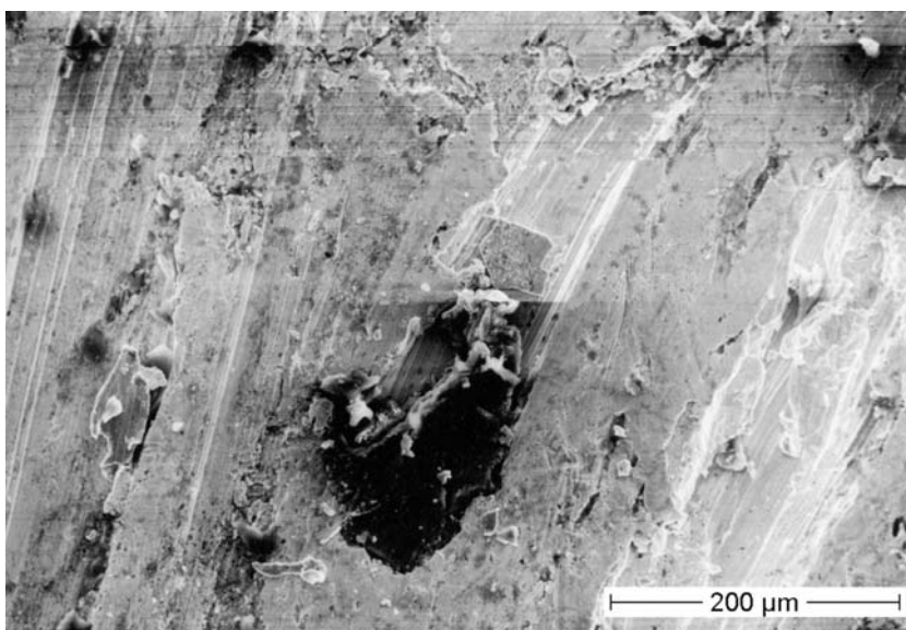
Bild 2: ein weiteres Teilchen in der Größe von 200 \mu\text{m} mit Schabespur
