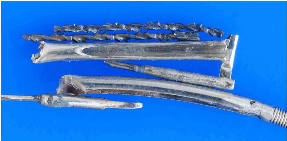
Bild 1. Die Bestandteile der Herzkatheterspitze: Sägeblatt (noch einmal nachträglich gebrochen). Das Halbrohr (bei der Rettungsoperation zerschnitten) und die beiden Zuganker für das Sägeblatt
