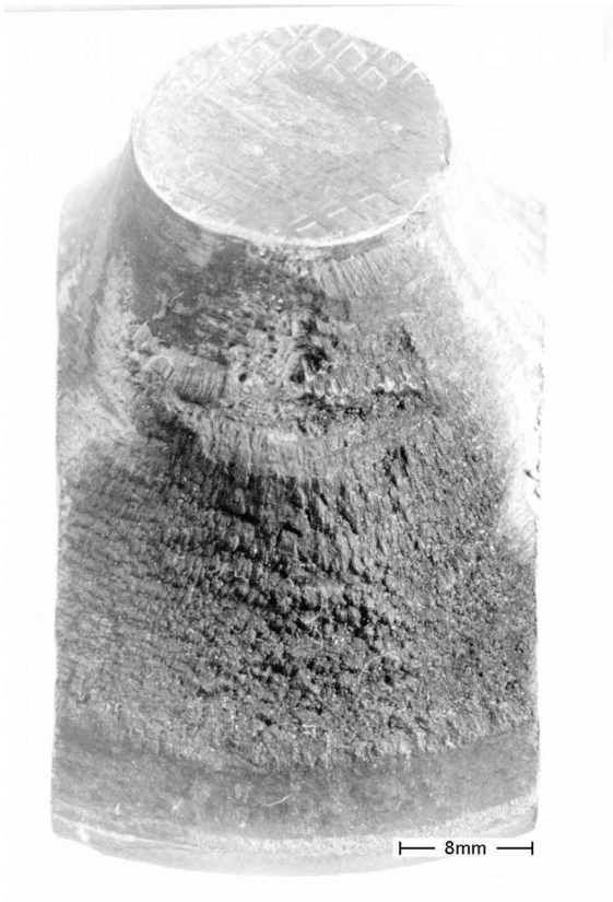
Bild 6: Auslassventil mit Ablagerungen
