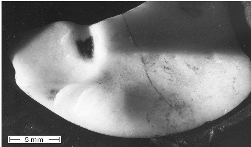
Bild 4: Teil 3, (Bruchlinie zu Teil 2); starke Einebnung der Strukturen
