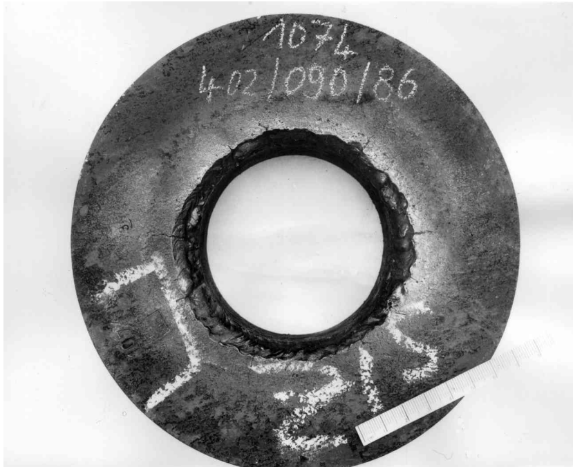
Bild 4: Eingeschweißter Stutzen DN 80, Ansicht von der Behälterinnenseite, mit Anrissen (Foto: ZIS Halle [2])
