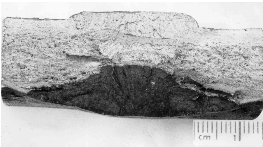
Bild 3: Aufgebrochener Querriss dunkel: „Alt-Anriss“- Fläche, innen hell: Restquerschnitt Gewaltbruch (Foto: ZIS Halle [2])
