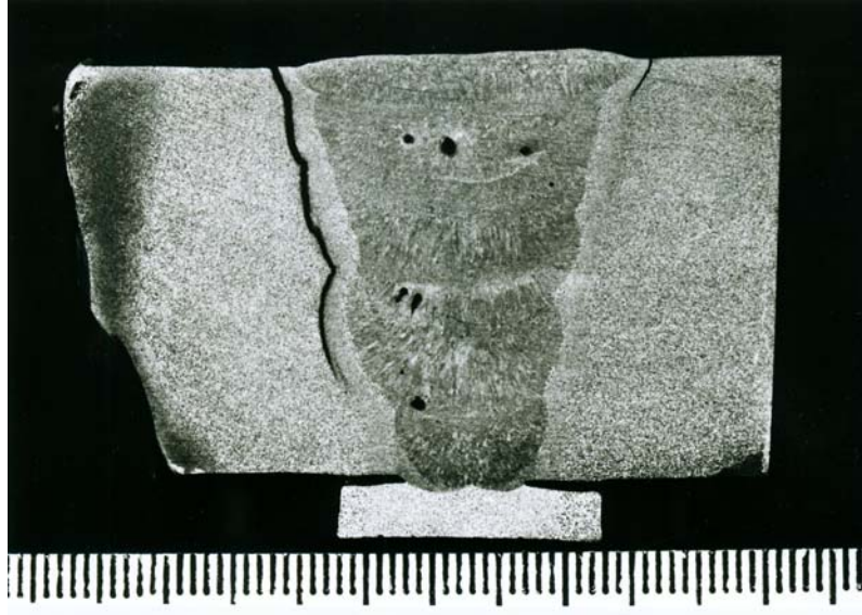
Bild N7: Heißdampfrohr mit Rundnaht, beidseitig Rissbildung (links ausgeprägt), enge Bindung der Risse an die interkritische Zone
