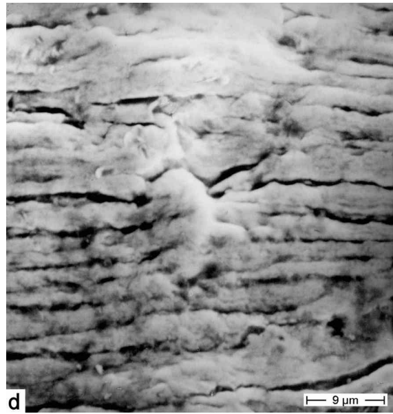
Bild 3 (a-d): Bruchbahnen mit Streifenstrukturen (Vergrößerungsfolge), R = Restbruch
