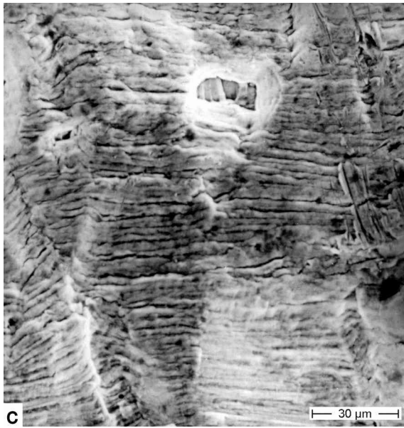
Bild 3 (a-d): Bruchbahnen mit Streifenstrukturen (Vergrößerungsfolge), R = Restbruch
