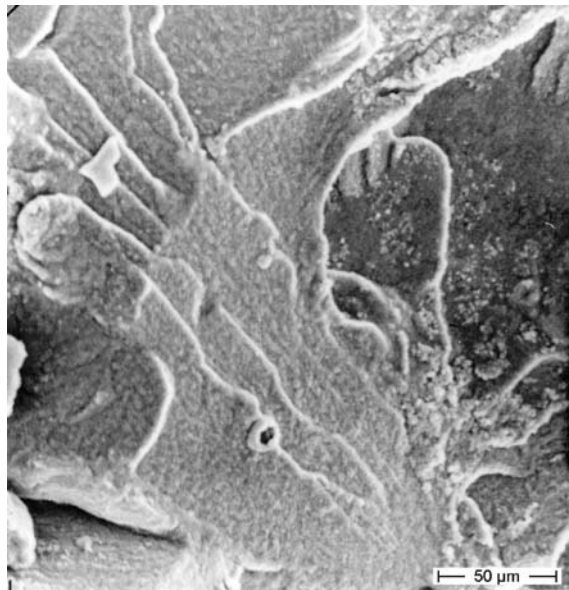
Bild 12: Spaltflächen durch Oxidschicht nachgebildet (Ausschnitt aus Bild 11)
