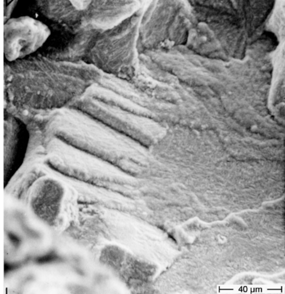
Bild 10: Spaltflächen durch Oxidschicht nachgebildet (Ausschnitt aus Bild 9)
