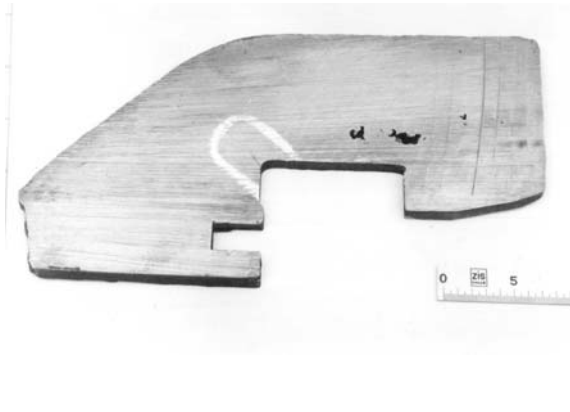
Bild 6: Risslage in einer Ecke, rechts Lunker
