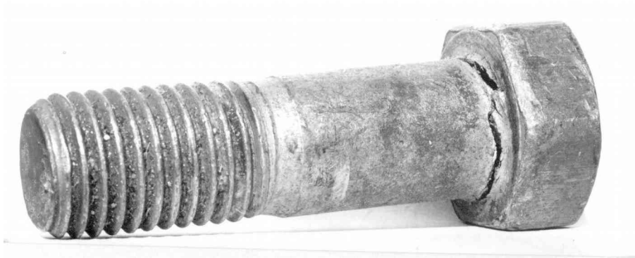
Bild 1: demontierte Schraube; Riss im Übergang zum Kopf, minimaler Zusammenhang
