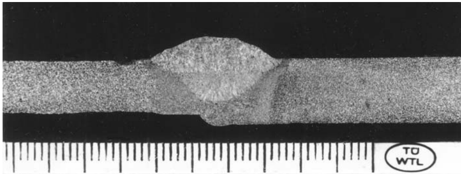
Bild 1: Originalnaht, Rohrwand links deutlich dünner, Kantenversatz unten
