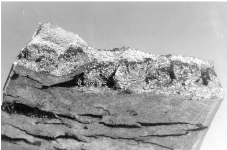
Bild 8 Makrodarstellung der Probe nach dem endgültigen Aufbrechen
