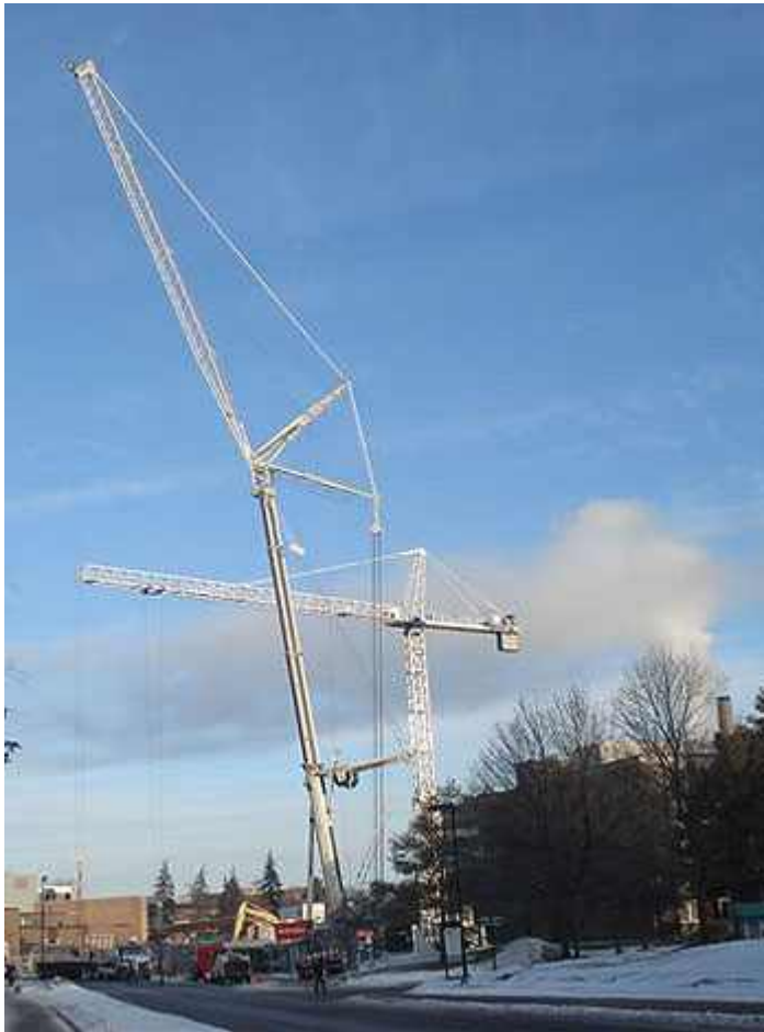
Bild 5: Turmkran mit zwei Gegenauslegern (Analogie zur Darstellung in Bild 4) Quelle: University of Waterloo
