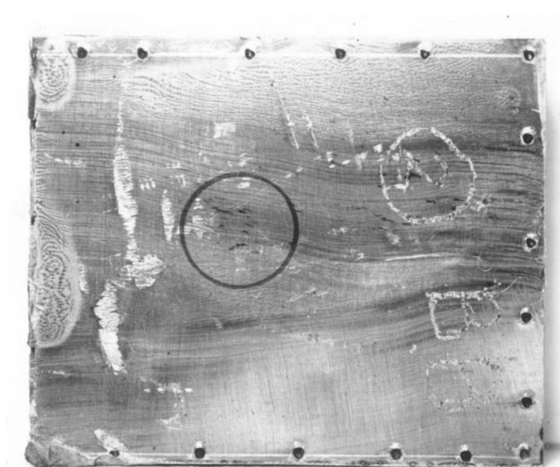
Bild 1: Innenfläche der Kappe, Schadstelle kreisförmig markiert (Foto: Auftraggeber)
