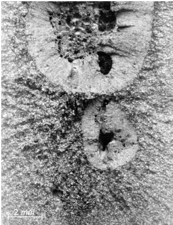
Bild 1. Zwei größere Fischaugen auf der Bruchfläche einer Schweißbiegeprobe
