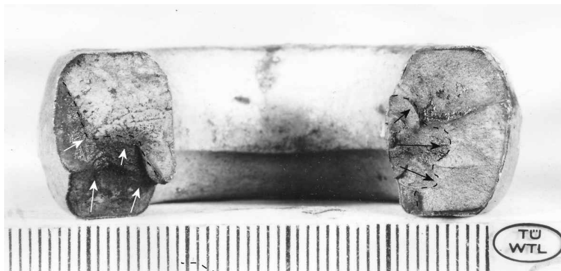
Bild 3: Bruchlinsen in den Ösenschenkeln, links vom Rand, rechts vom Schmiedegrat ausgehend
