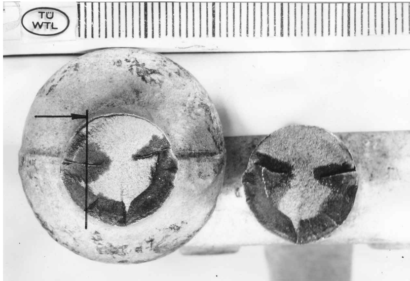
Bild 2: die beiden Bruchflächen des Knaufansatzes; oxidierte Anrisse verteilt über den Umfang, tieferes Eindringen am Schmiedegrat; Schnitt für Metallographie eingezeichnet
