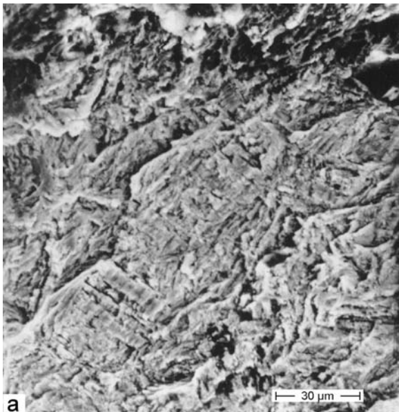
Bild 6 (a und b): Risseinlauf, transkristalline Bruchbahnen mit Andeutung einer Querstreifung
